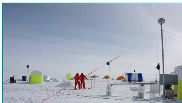
*Das Bohr-Camp (von links nach rechts): Generatorzelt, Toilettenzelt, vier kleine Schlafzelte, Gemeinschaftszelt, zwei Bohrzelte. Im Vordergrund der aufgebaute Eisbohrer, sichtbar der abgespannte Bohrturm mit Umlenkrolle für Bohrkabel und Bohrer.*
